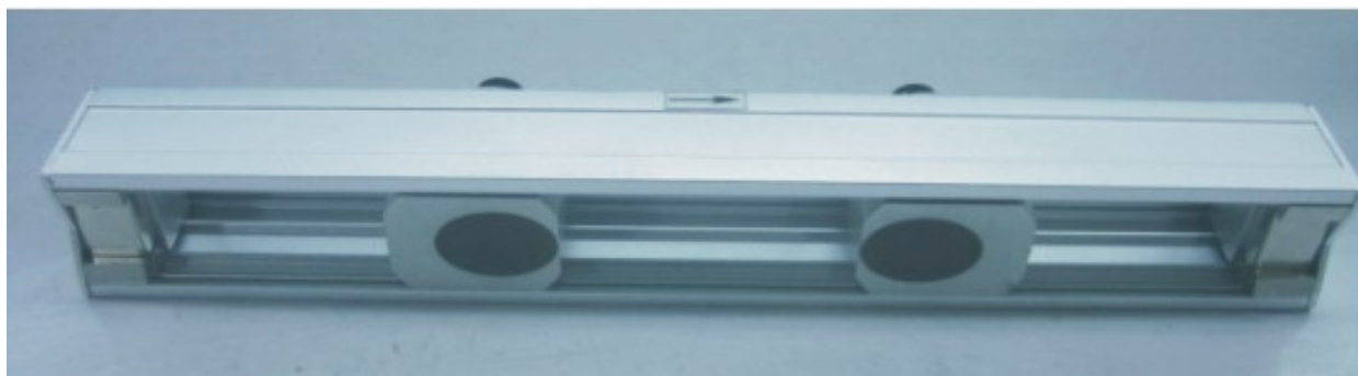
Figura 3-23 instalando os dois transdutores em uma régua
