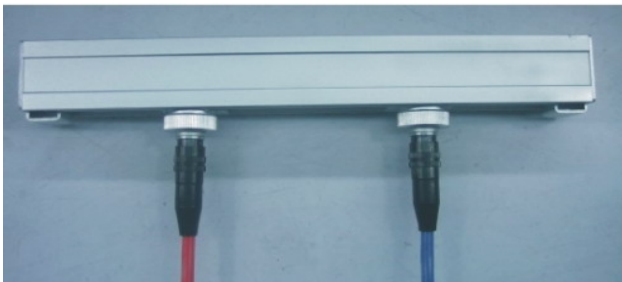
Figura 3-24 instalando os dois transdutores em uma régua para medição
