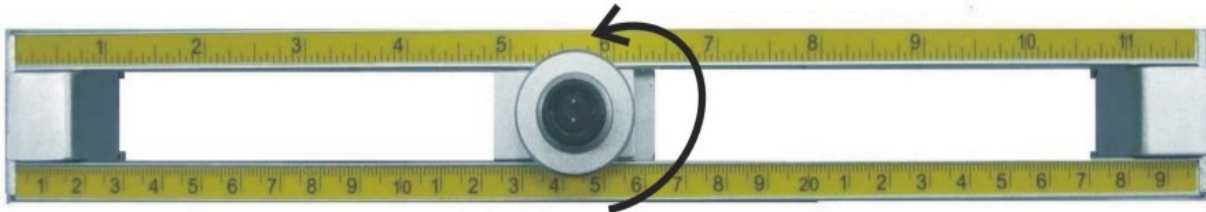
Figura 3-18 Régua com transdutores integrados
