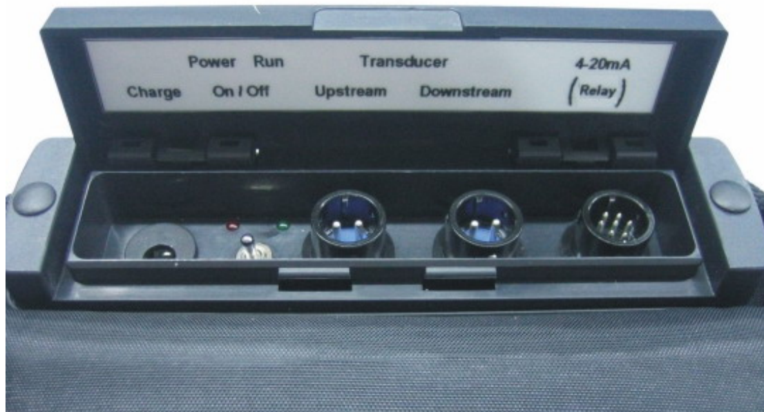
Figura 2-1 Painel de conexão
